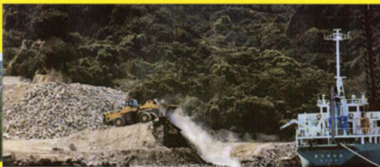
香川県 小豆島当浜地区 砕石を海水で洗浄し運搬船に積み込む(2016.8.27撮影)
